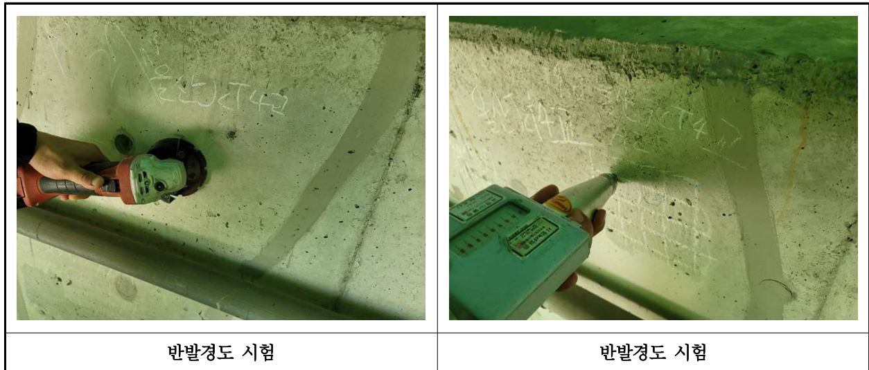
【사진 34.4.2】 반발경도시험 현장사진
